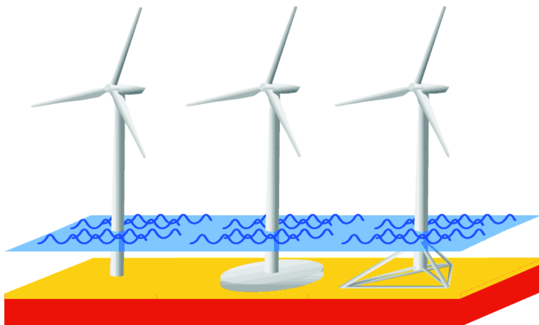
Abbildung 2: Mögliche Gründungskonzepte für WEA (Monopile - Schwerkraftfundament - Tripod)
