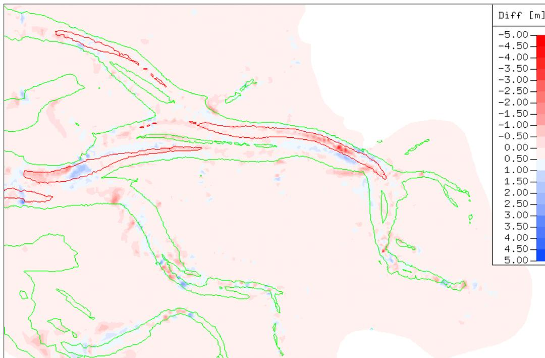
Abbildung 4.68: Ergebnisse der Simulation über 20 Tage (Sep.96) mit Welleneinfluss, Formulierung Bijker, Differenzendarstellung
