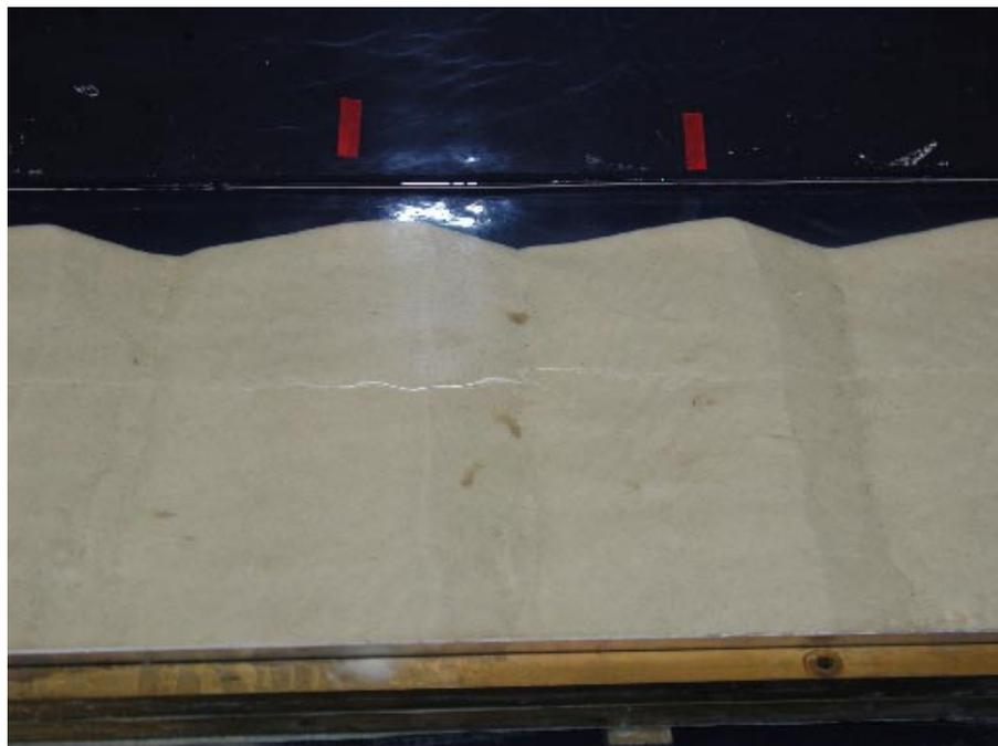
Abbildung 3.16: Bodenform nach 5 Minuten Überströmung
